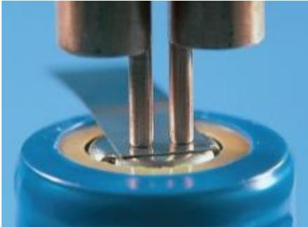
Soudage de languettes de batteries
